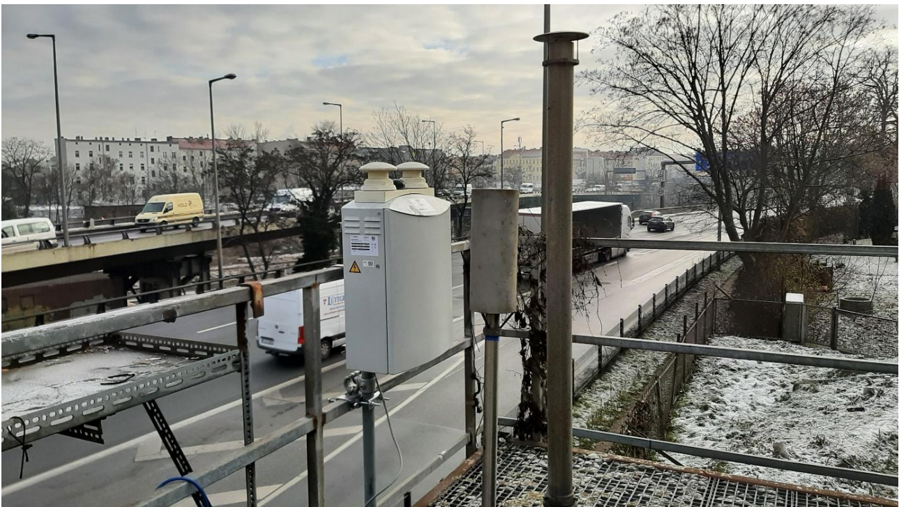
Abbildung 6: Messung mit einem Sensorsystem an der Sondermessstation MC014 zur Erfassung der Luftschadstoffbelastung in der Nähe der A100 im Bezirk Charlottenburg-Wilmersdorf.
