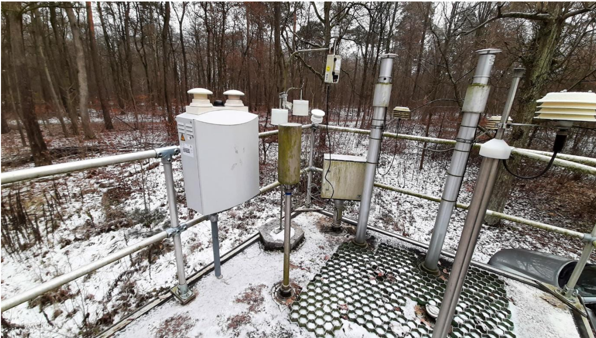
Abbildung 7: Sensorsystem an der Messstation MC077 Buch am Stadtrand zur Prüfung des Messsystems bei geringer Stickstoffdioxid- und Partikelkonzentration.
