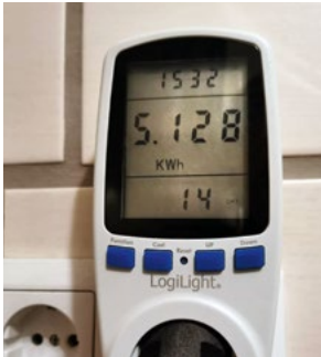
Abb. 4 | Energiemessgerät hat innerhalb von 14 Tagen an einem Kühlschrank einen Energiebedarf von 5,128 kWh gemessen
