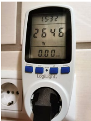
Abb. 2 | Energiemessgerät bei der Messung der aktuellen Leistung (Watt) eines elektrischen Wasserkochers
