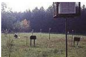
Eintragsmessungen auf der Freifläche
