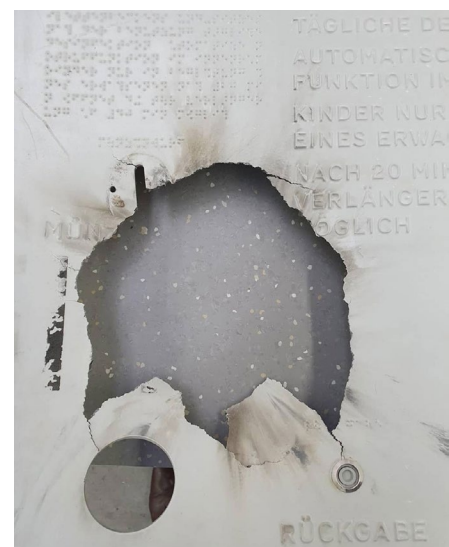
Abbildung 8: Schaden an einer Berliner Toilette durch Einbruchsversuch
