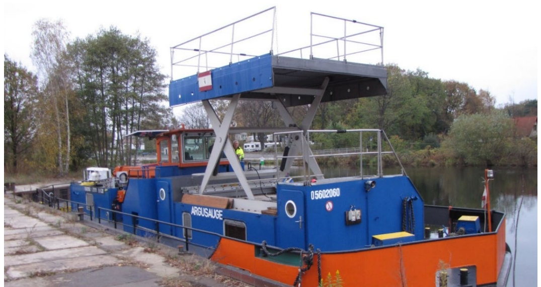
Abb. 6 - Prüfschiff Argusauge zur Bauwerksprüfung von Ingenieurbauwerken, Bild: SenMVKU
