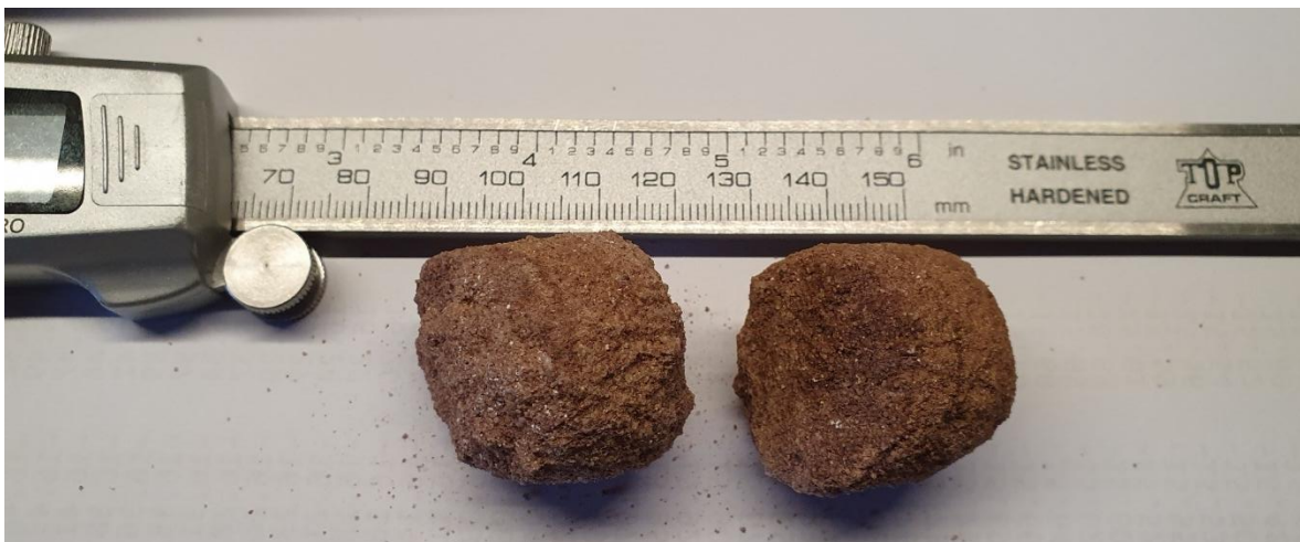
Abbildung 12: Gesteinsbruchstücke nach der versuchten Kernbohrung. (Foto: Goldberg (2025))
