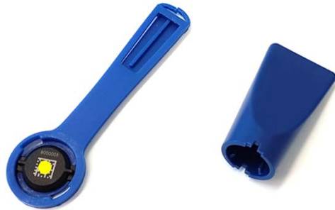
Abbildung 3: Stirnbandadapter mit ALD. Der gelbe Punkt markiert den Bezugspunkt für die Referenzbestrahlung. Rechts: Werkzeug zum Einlegen und Entnehmen des ALD.
