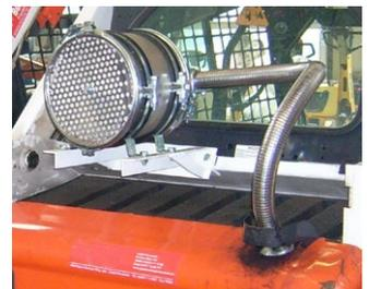
Abb. 14: Wechselfilter
