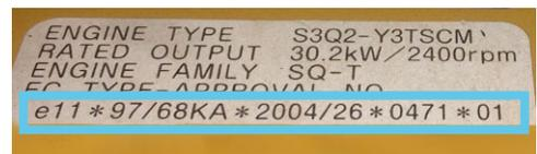
Abb. 7: EG-Typgenehmigungsnummer auf Baumaschinenmotor
