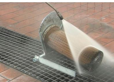
Abb. 30: Reinigung des Filters mit Hilfe eines Hochdruckwasserstrahls
