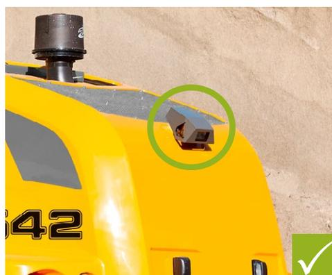
Abb. 19: Falsche und richtige Platzierung des Partikelfilters im Vergleich
