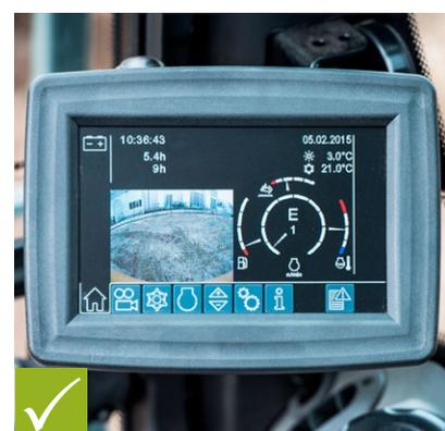
Abb. 20: Beispiele für zusätzliche Spiegel- und Kameramontierung, Monitor in Führerhaus
