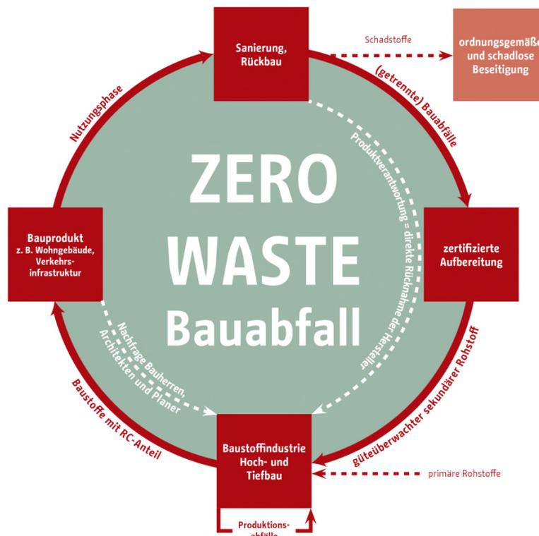
Abbildung 24: *Zero Waste*-Strategie für Bauabfälle (schematisch)
