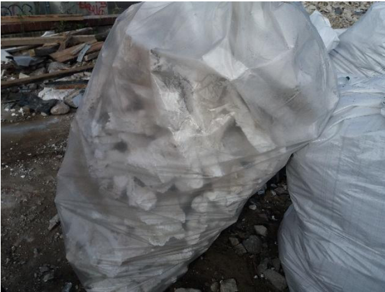
Abbildung 7: Abgetrenntes flammeschutzmittelfreies EPS aus Betonsandwichelementen und unter Estrich
