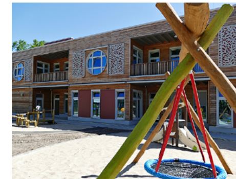
2 Für die Kita Havelländer Ring dienen Holz und Schafswolle als Bau- bzw. Dämmmaterialien. Das Dach wurde als Gründach konzipiert. Neben Fernwärme kommt eine Photovoltaik-Anlage für die Energiegewinnung zum Einsatz. © Anka Stahl
