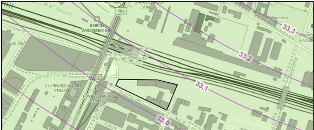
Abbildung 2: Bemessungsgrundwasserstand zeMHGW im Plangebiet [U2]
