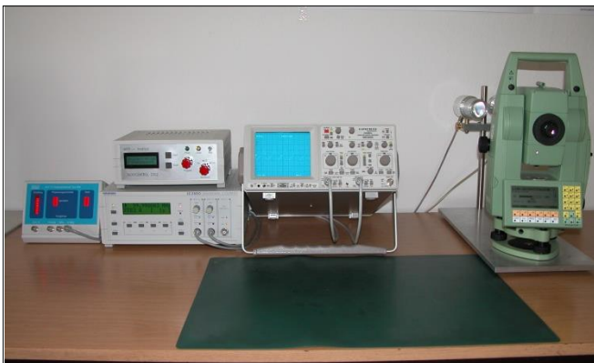
Bild 1: Frequenzprüfeinrichtung bei SenStadtWohn III
