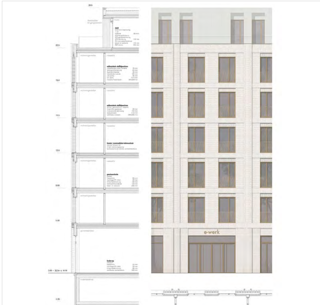
▲ Fassadendetail, Ansicht und Schnitt (TN)
