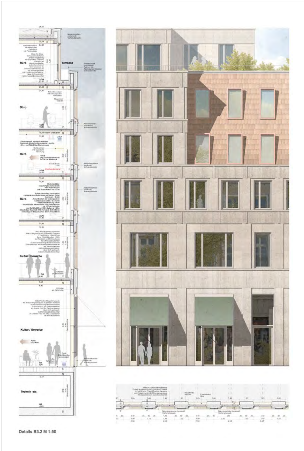
▲ Fassadendetail, Ansicht und Schnitt (TN)
