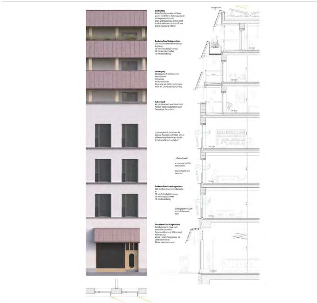
▲ Fassadendetail, Ansicht und Schnitt (TN)
