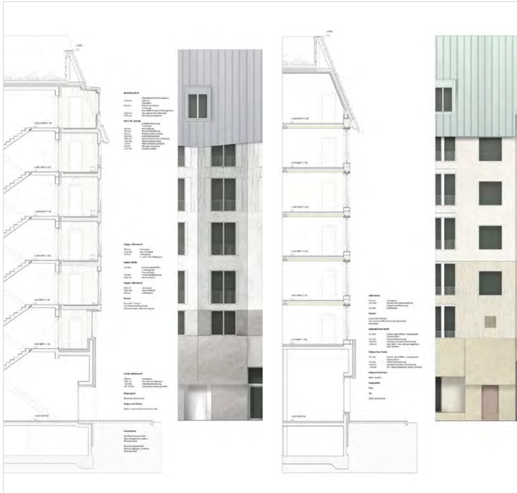
▲ Fassadendetail, Ansicht und Schnitt (TN)
