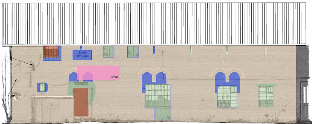
Abb. 9 Stall für kranke Pferde, Ansicht Nord mit Kartierung der Bauepochen (Auszug Denkmalpflegeplan, 2020)
