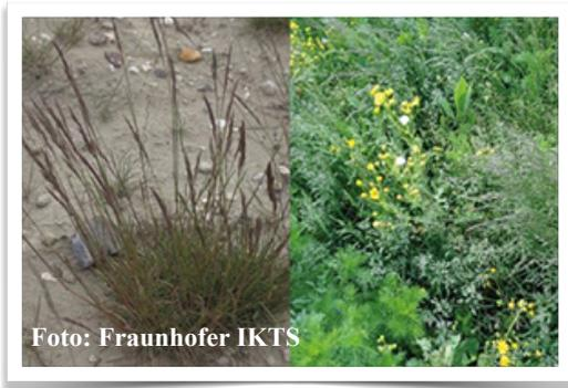
Links: Die unbehandelte Deponiefläche mit karger Begrünung. Rechts: Die vollständig begrünte Versuchsfläche nach Rekultivierung der Deponiefläche mit Pilz-Klärschlamm-Mischung.
