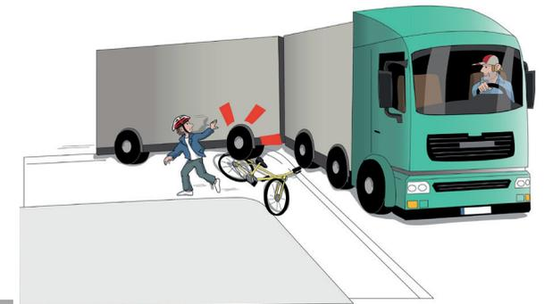
Der Anhänger wird durch den deutlich engeren Radius zur besonderen Gefahr.
