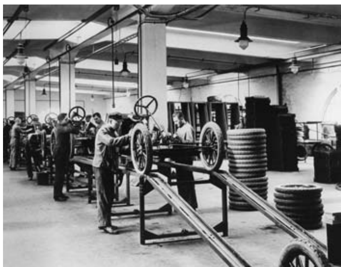
Das Fließband hält Einzug in die Produktion: Bandmontage von Fahrgestellen der Hanomag-Werke 1925 in Hannover-Linden
