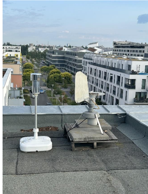
Abb. 8: Pollensammler Sigma-2 AD (links) und Burkard Pollenfalle (rechts)
