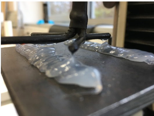
Bild 6: Brückenbildung bei 30 °C warmem Klebestrang
