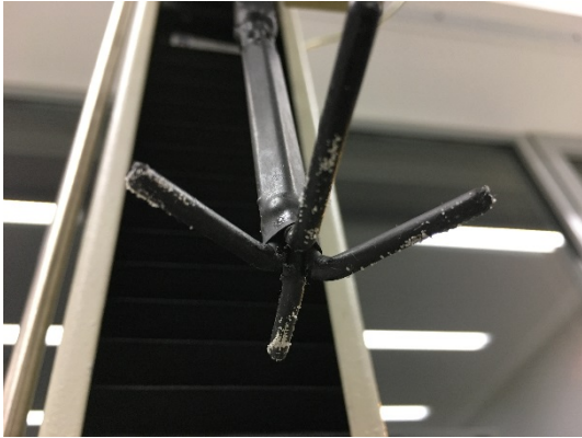
Bild 5: Taubenfüße nach Test mit Quarzsandauflage, nach (a) Aufsitzen bzw. (b) Trippeln
