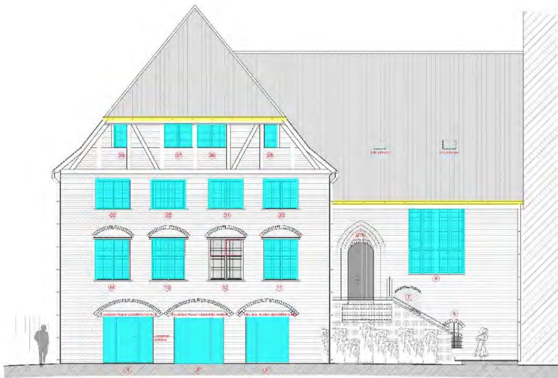
Stadthauptmannshaus – sanierte Bauteile Ostansicht
