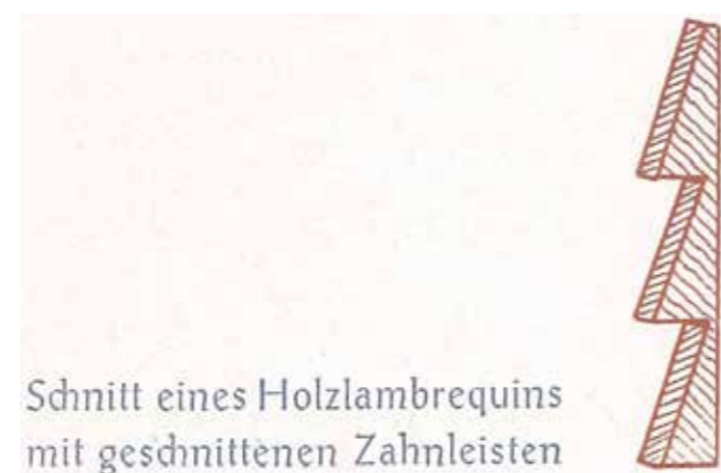
Historisches Produktblatt Fa. Bockstaller, Schnitt durch eine Holzschabracke
