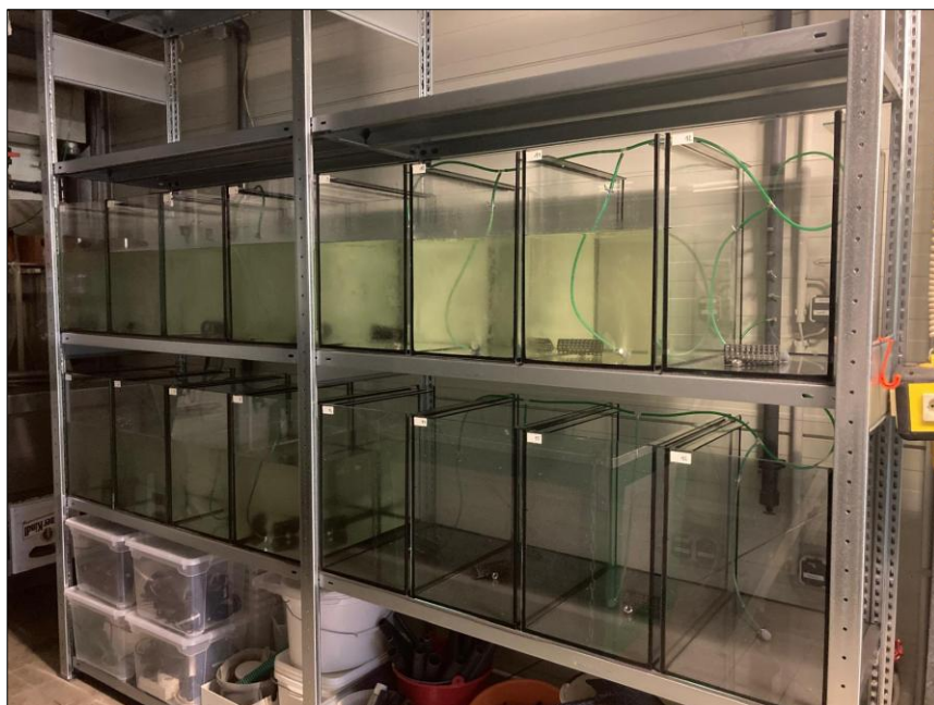
Abb. 2: Aquariumanlage mit Ausströmern (Druckluft) und Versteckmöglichkeit für die Hälterung von Glasaalen
