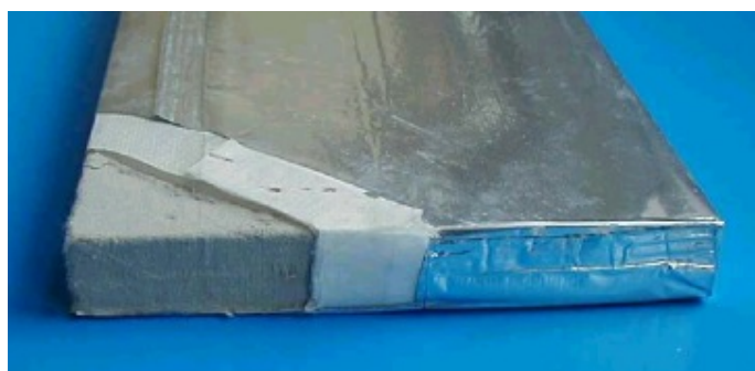
Abbildung W21: Prinzip der Wärmeleitung in den Vakuum-Dämmplatten (links, www.vakuum-isolierung.de ) und Standardaufbau einer Dämmplatte: Kern aus pyrogener Kieselsäure und Hochbarrierehüllfolie (rechts, va-q-tec).
