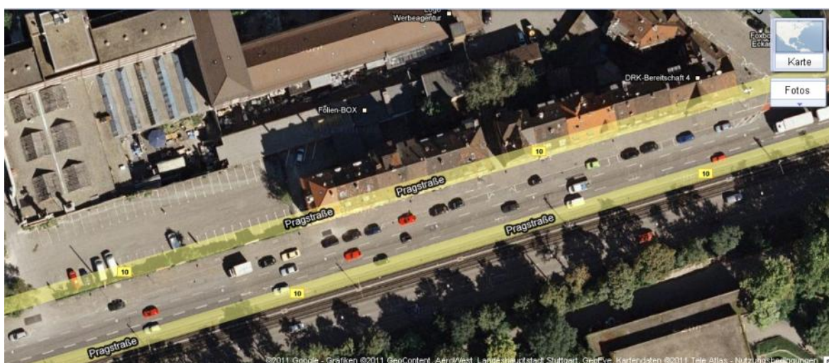
Abbildung AA1: Messort für Straßenlärm, Pragstraße in Stuttgart-Nord. Lärmpegelbereich laut Lärmkarte der Stadt Stuttgart 75 bis 80 dB(A) tags, 70 bis 75 dB(A) nachts.
