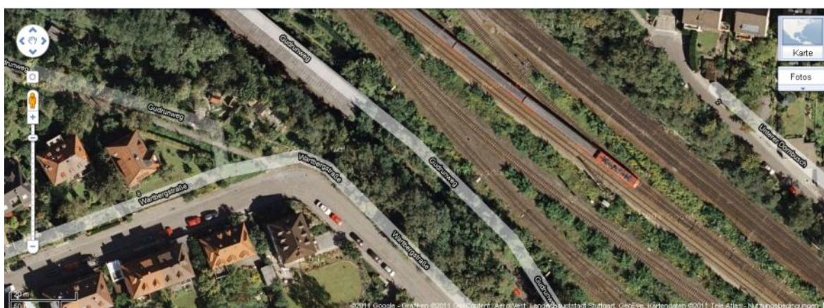
Abbildung AA1: Messort für Zuglärm, Gudrunweg in Stuttgart-Nord. Lärmpegelbereich laut Lärmkarte des Eisenbahnbundesamtes > 75 dB(A) tags, 65 bis 70 dB(A) nachts.
