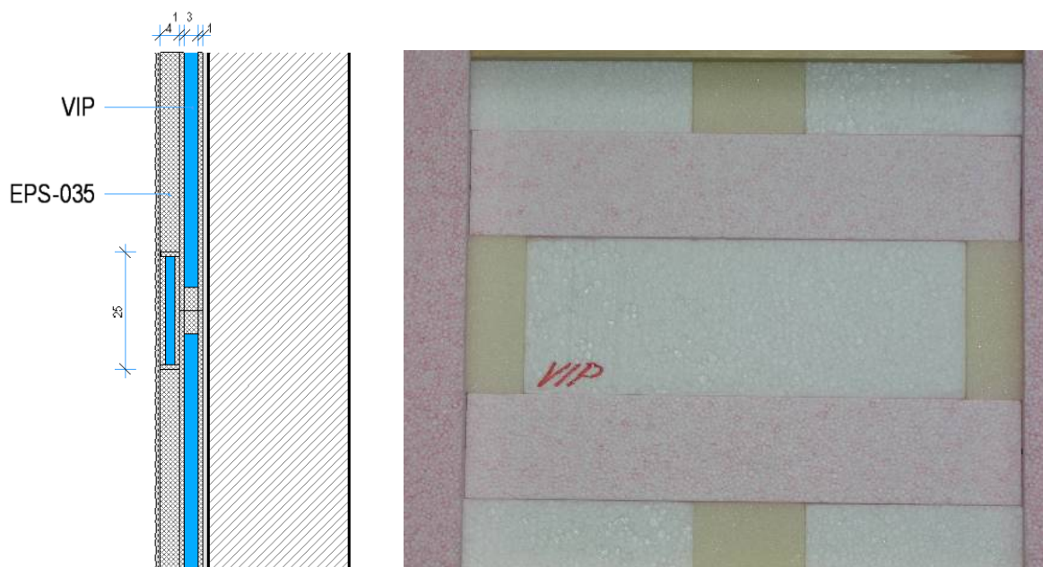
Abbildung W25: Das LockPlate-Dämmsystem der Fa. Weber, Plattendicke 90 mm (VIP 30 mm): U_{\text{Planerisch}}=0,14 \text{ W}/(\text{m}^2\text{K}) , Plattendicke 110 mm (VIP 40 mm): U_{\text{Planerisch}}=0,11 \text{ W}/(\text{m}^2\text{K})
