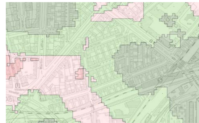
Mächtigkeit der obersten stark bis mittel wasserdurchlässigen Schicht in m unter Geländeoberkante 0 - 1,0 m > 1,0 - 2,0 m > 2,0 - 5,0 m > 5,0 m
