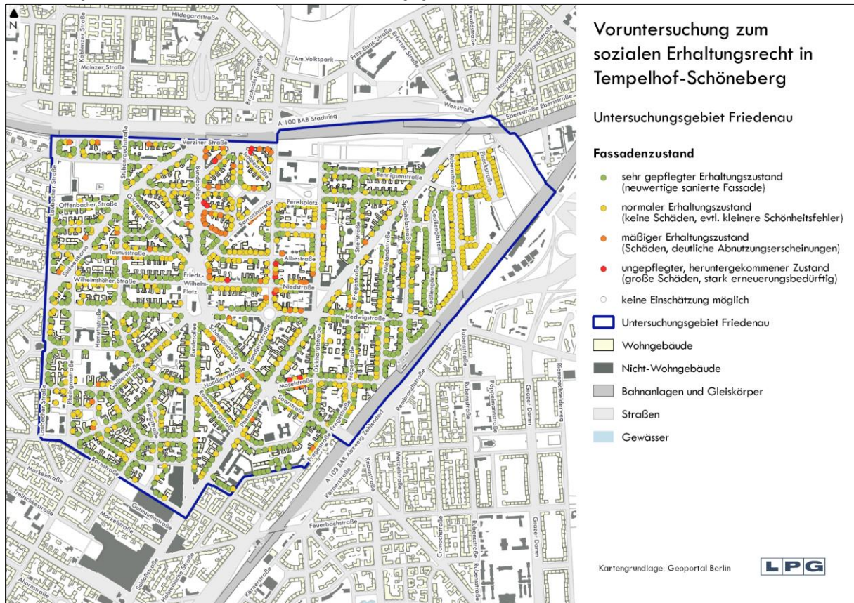
Abbildung 16: Fassadenzustand im Untersuchungsgebiet
