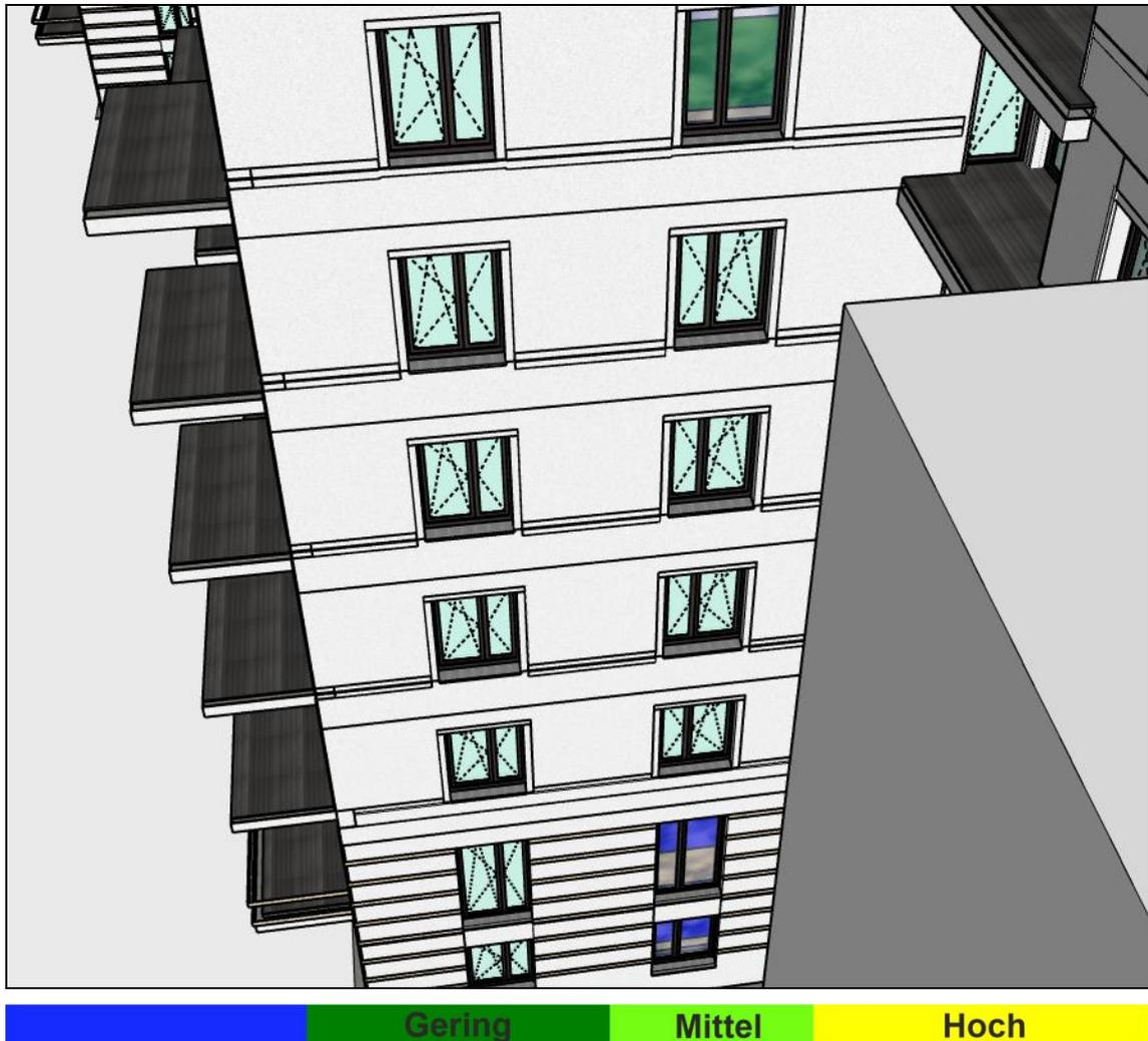
**Abb. 13:** Ergebnisse der Tageslichtprognose nach DIN EN 17037 ausgewiesen als Empfehlungsstufen für die Mindestziel-Beleuchtungsstärke in drei Wohnräumen im Bauteil B4
