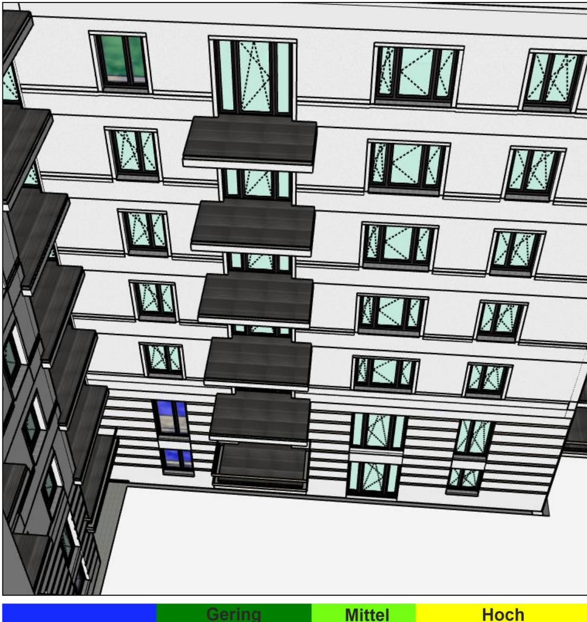
**Abb. 12:** Ergebnisse der Tageslichtprognose nach DIN EN 17037 ausgewiesen als Empfehlungsstufen für die Mindestziel-Beleuchtungsstärke in drei Wohnräumen im Bauteil B3
