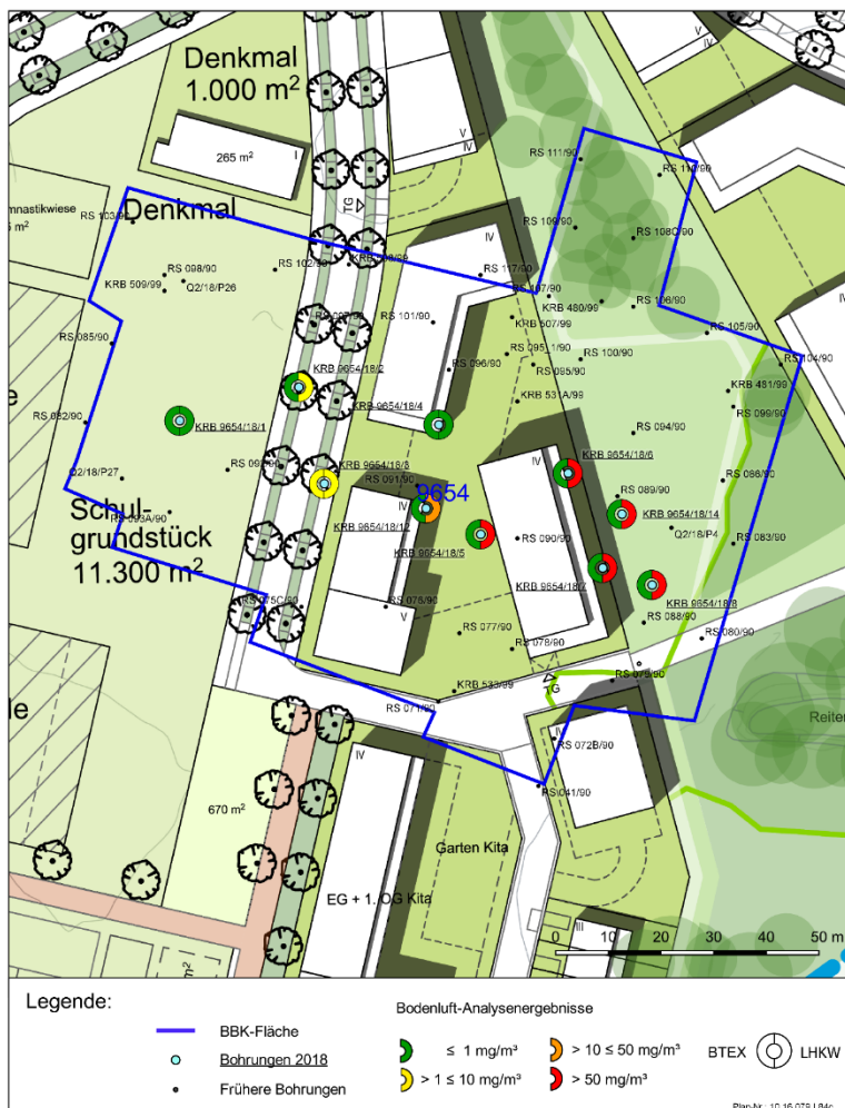
Abbildung 9: LHKW-Verteilung in der Bodenluft (2018) auf der BBK-Fläche 9654.
