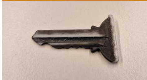
Durch Täter hergestellter Kunststoffschlüssel von der Abformung
