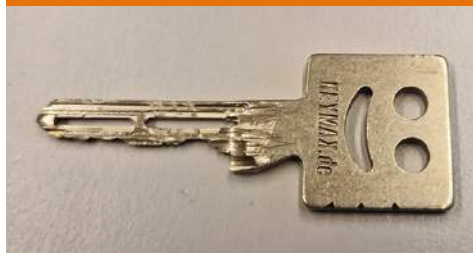
Durch Täter bearbeiteter Schlüsselrohling
