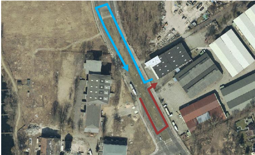
Abb. 8: Anschluss Daumstraße und Mittelstreifendurchbruch
