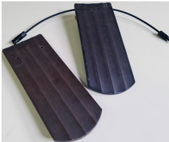
Abbildung 21 Auch Biberschwanzdachziegel können imitiert werden - hier die Einzelanfertigung eines Musters mit Pressglasoberfläche.
