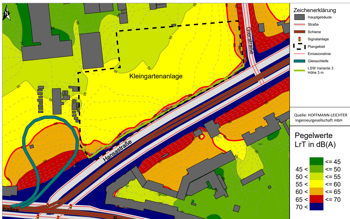
Abbildung 3-5 Isophonenkarte in 2 m Höhe über Gelände mit einer LSW von 3 m Höhe, Beurteilung nach DIN 18005 , 06- 22 Uhr (Variante 3)
