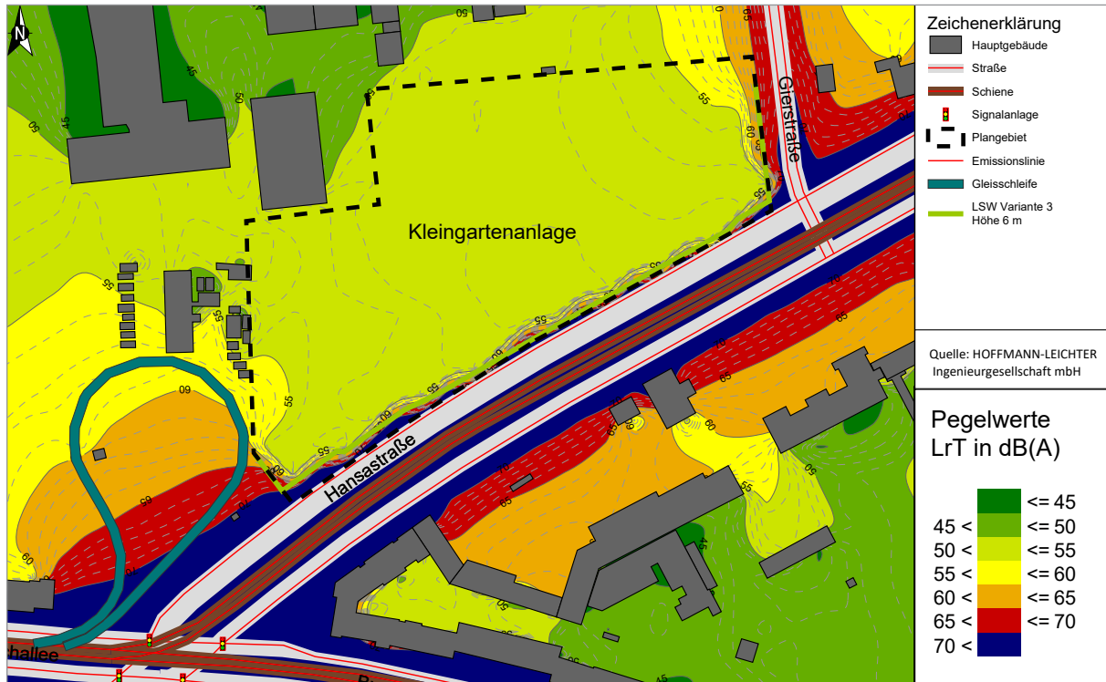
Abbildung 3-2 Isophonenkarte in 2 m Höhe über Gelände mit einer LSW in Höhe von 6 m, Beurteilung nach DIN 18005, 06- 22 Uhr (Einhaltung von 55 dB(A))
