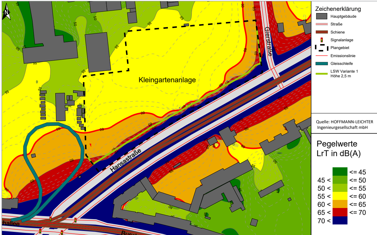
Abbildung 3-3 Isophonenkarte in 2 m Höhe über Gelände mit einer LSW von 2,5 m Höhe, Beurteilung nach DIN 18005 , 06- 22 Uhr (Variante 1)
