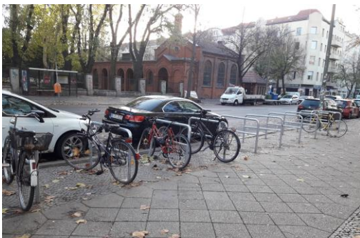
Abbildung 1: Aufstellung im Unterstreifen waagrecht zur Gehbahn
