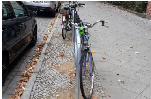
Abbildung 2: Aufstellung im Unterstreifen parallel zur Gehbahn
