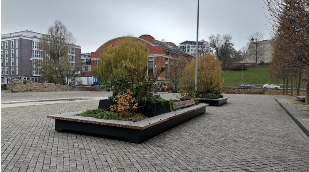
Abb. 14 Begrünte Sitzelemente mit integrierter Zisterne (eigenes Foto)
