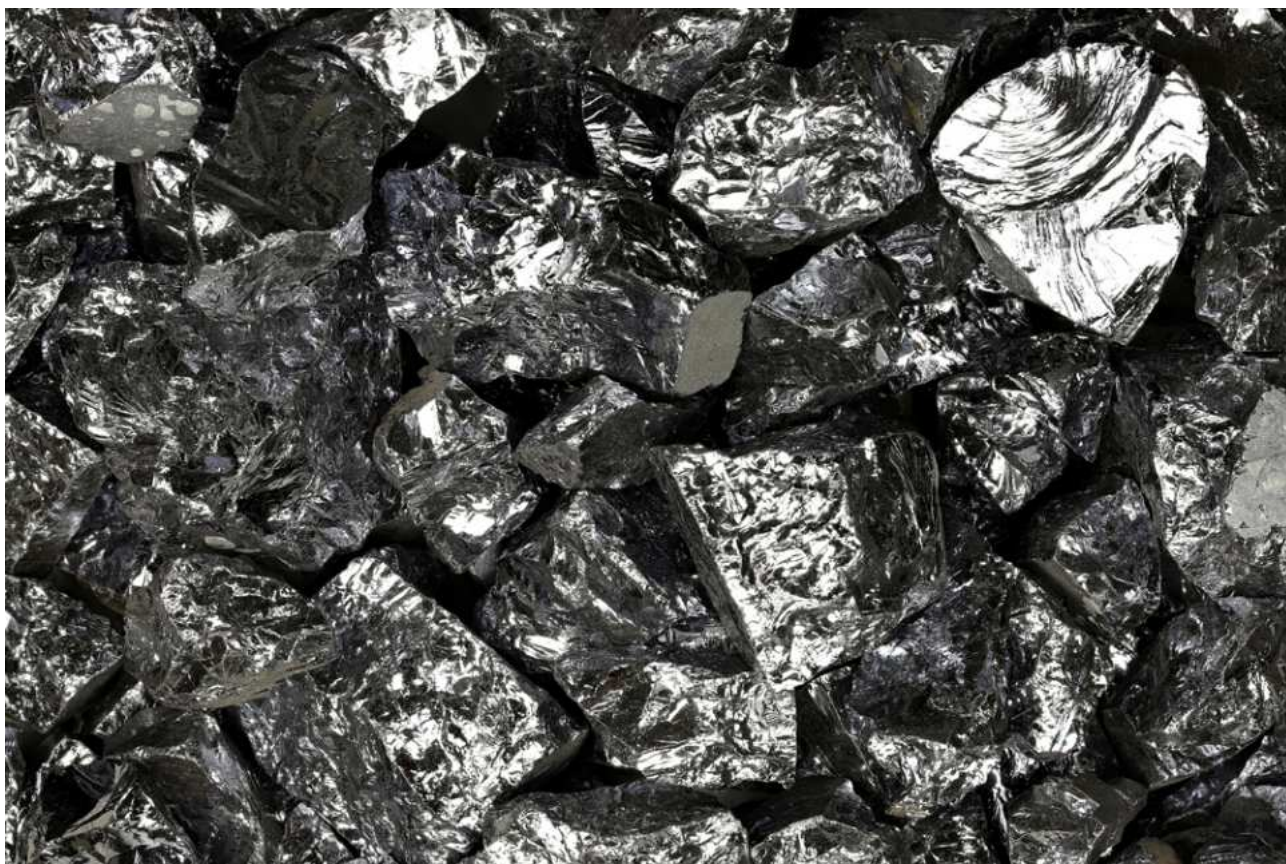
Polykristallines Silizium, wie hier zu sehen, wird aus Rohsilizium gewonnen und ist für den Großteil aller Solarmodule weltweit essentiell.
