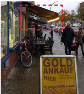
(-) Niedrige Durchgangshöhe der Markise wird durch Lichterkette zusätzlich verringert; Gefahr für Passanten
