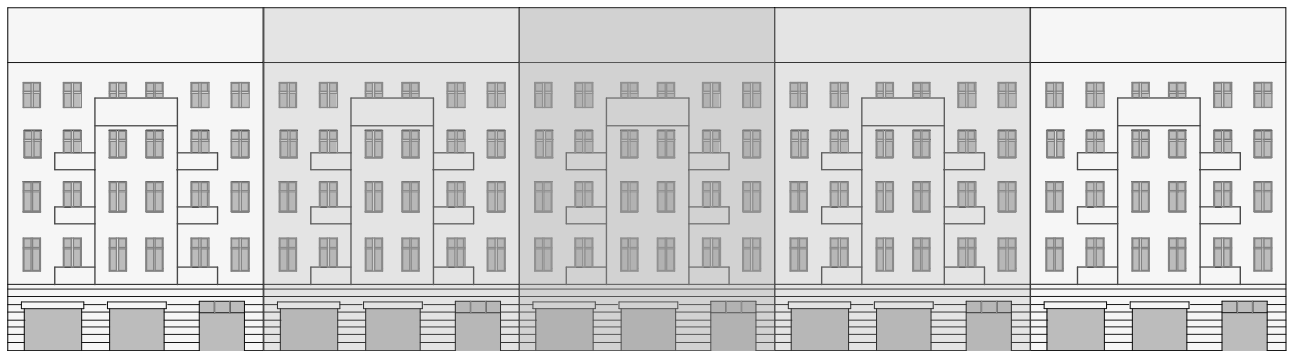
Abb.: Schematischer Farbverlauf für eine Blockrandbebauung - äußere Bauten hell; zur Blockmitte hin dunkler - konkave Wirkung
