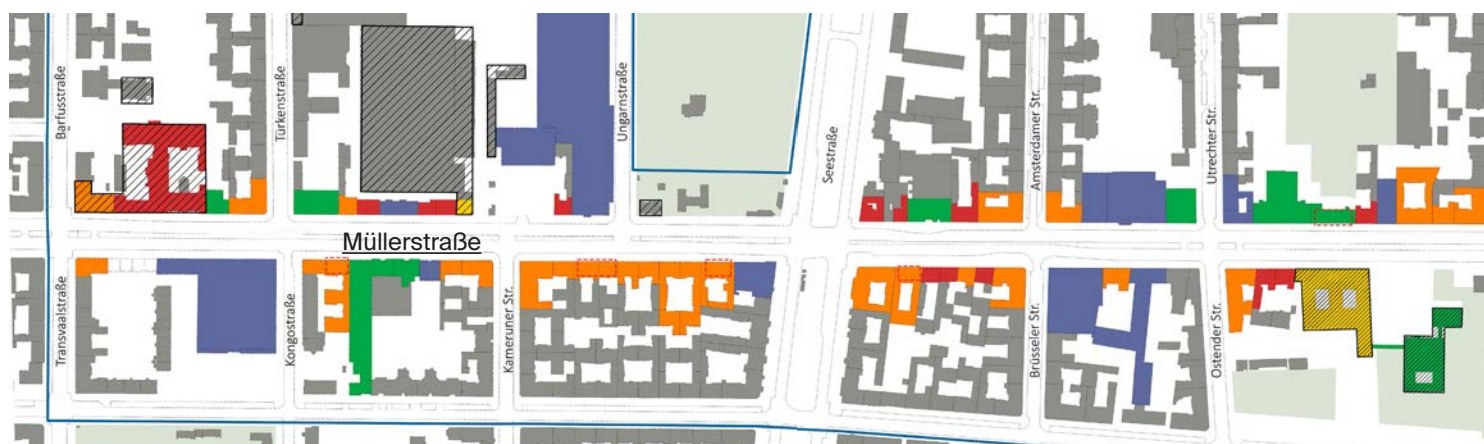
Abb. diese und nächste Seite: Baualterklassen in der Müllerstraße 8
