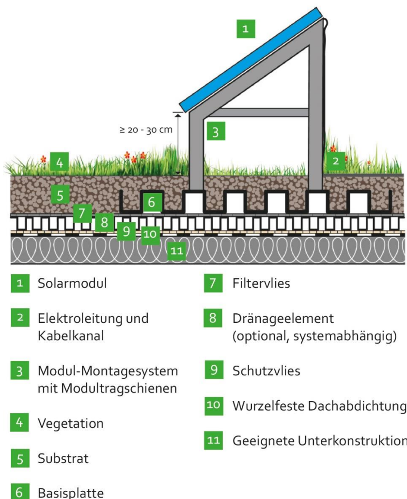
Abbildung 8: Schematischer Schnitt durch ein auflastgehaltenes Solar-Gründach
