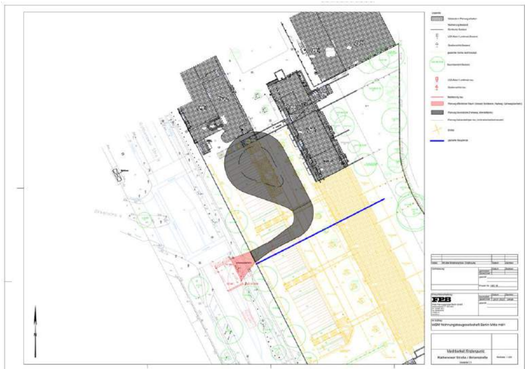
Abbildung 5: Variante 1.1 (Wendeschleife 25 m)
