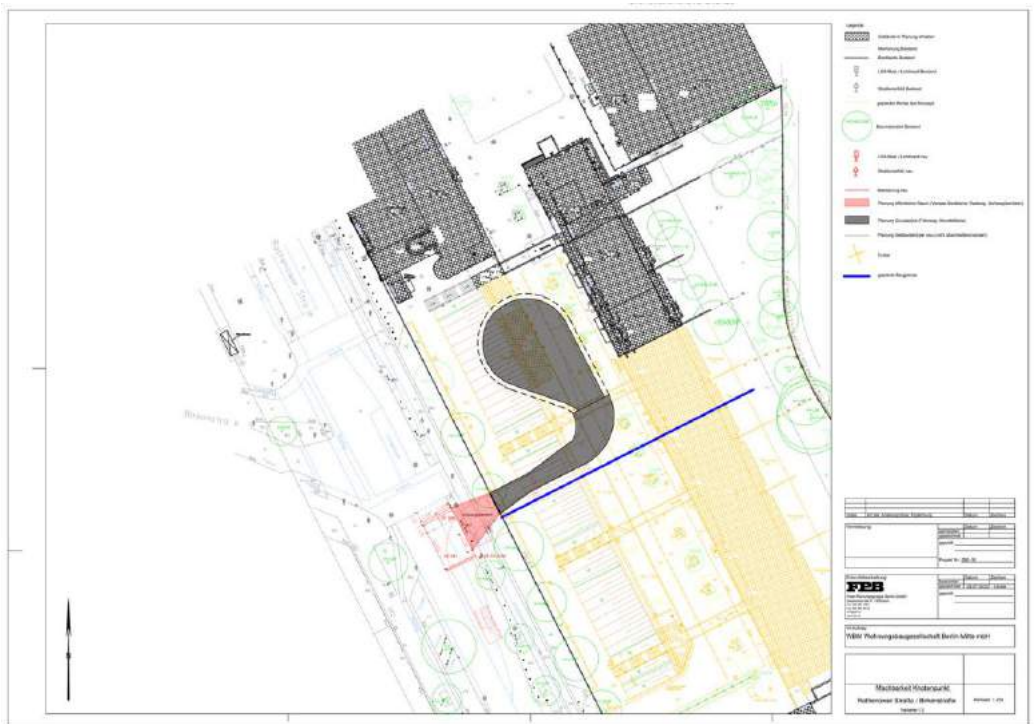
Abbildung 6: Variante 1.2 (Wendeschleife 20 m)
