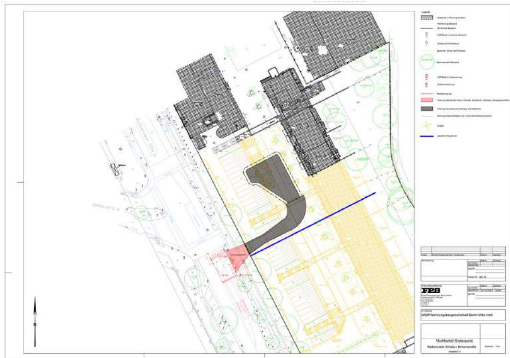
Abbildung 7: Variante 1.3 (Wendehammer links 17 m)
