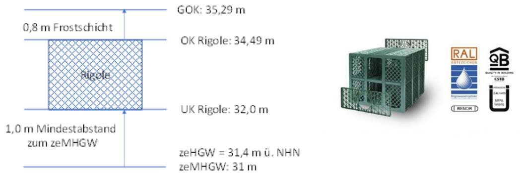
Abbildung 5: Höhenprofil für den Einbau von Rigolen.
