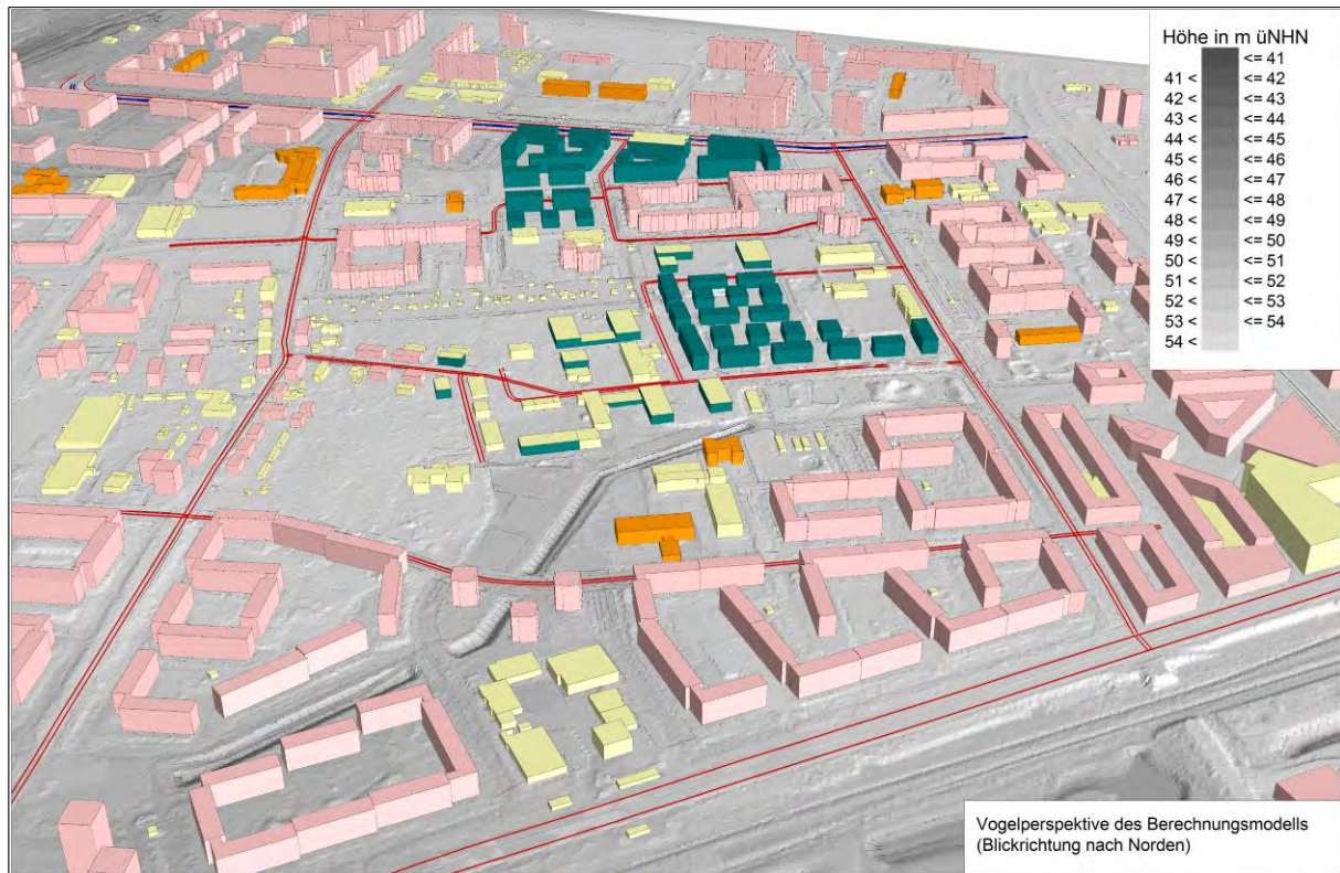
Abbildung 3: Vogelperspektive mit Blickrichtung Norden des mit dem Programm Sound-PLAN /85/ erstellten Berechnungsmodells (vorhandene Hauptgebäude/ Nebengebäude in Rosa/Gelb, geplante Gebäude in Petrol, Schulen, Kitas etc. in Orange, Gleise der Straßenbahn in Blau, Emissionslinien der Straßen in Rot)
