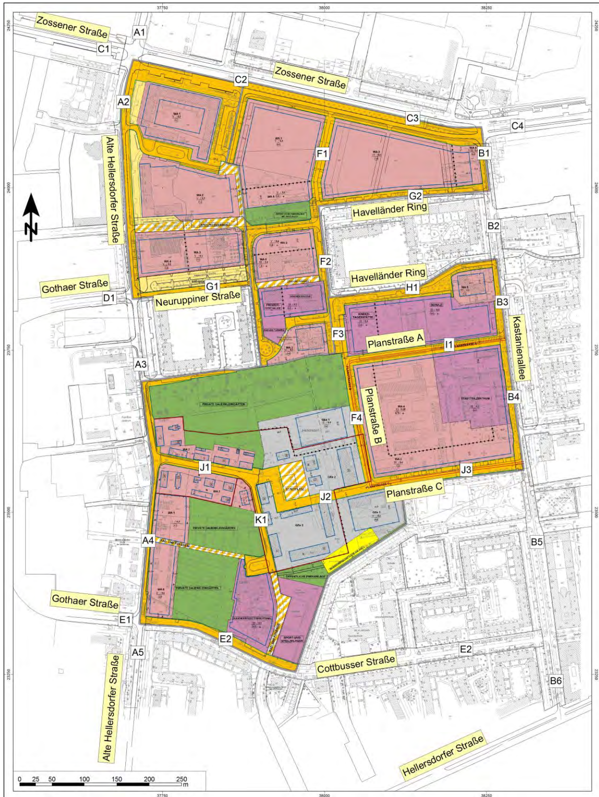
Abbildung 25: Bezeichnungen der Straßenabschnitte (A1, A2, ... bis K1) gemäß /72/ In den Berechnungen der Strategischen Lärmkarten 2012 der Senatsverwaltung für Stadtentwicklung und Umwelt wurden nur Straßen des Hauptstraßennetzes berücksichtigt (s. Abbildung 26 mit Verweis auf Abbildung 23 auf Seite 26).
