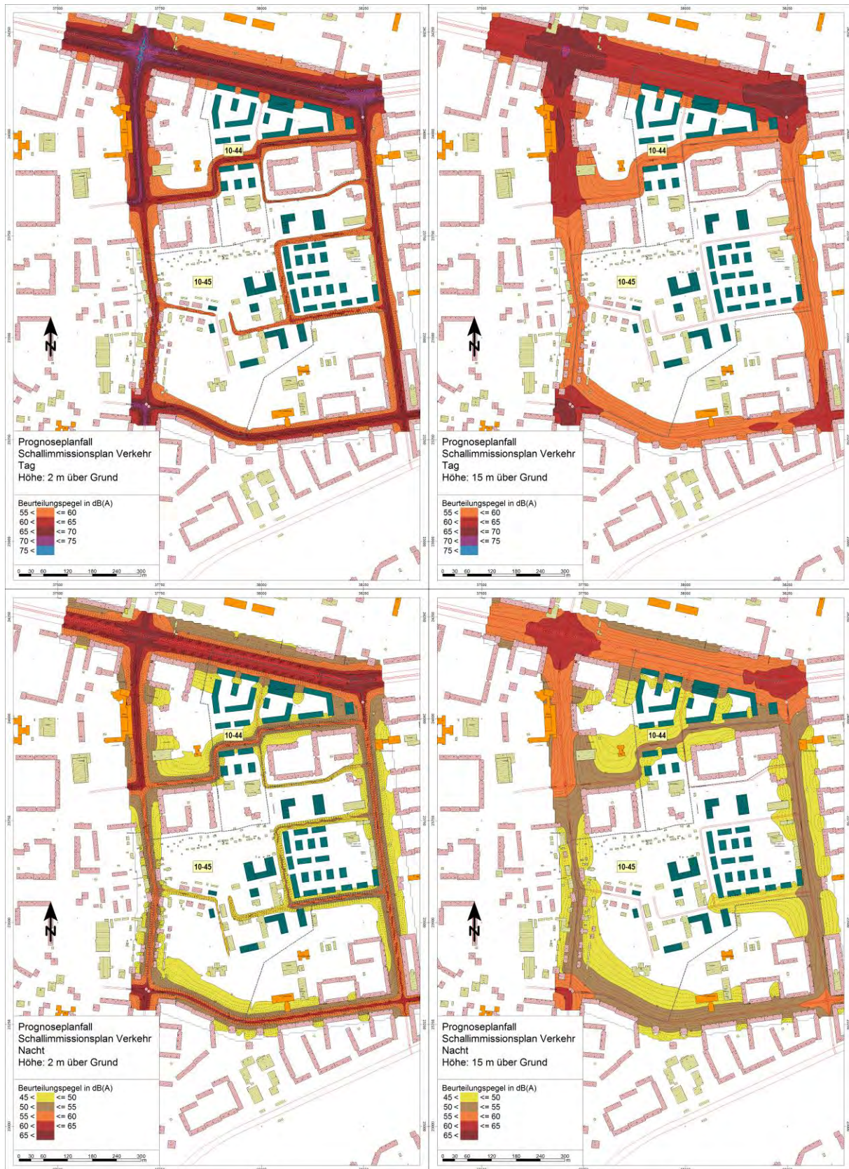
Abbildung 39: Schallimmissionspläne für Verkehrslärm im Prognoseplanfall: Bereiche 2/15 m (linke/rechte Bilder) Höhe ü. G. mit Überschreitungen der schalltechnischen Orientierungswerte tags/nachts (Bilder unten/oben) von 55/45 dB(A) für allg. Wohngebiete gemäß Beiblatt 1 zu DIN 18005-1
