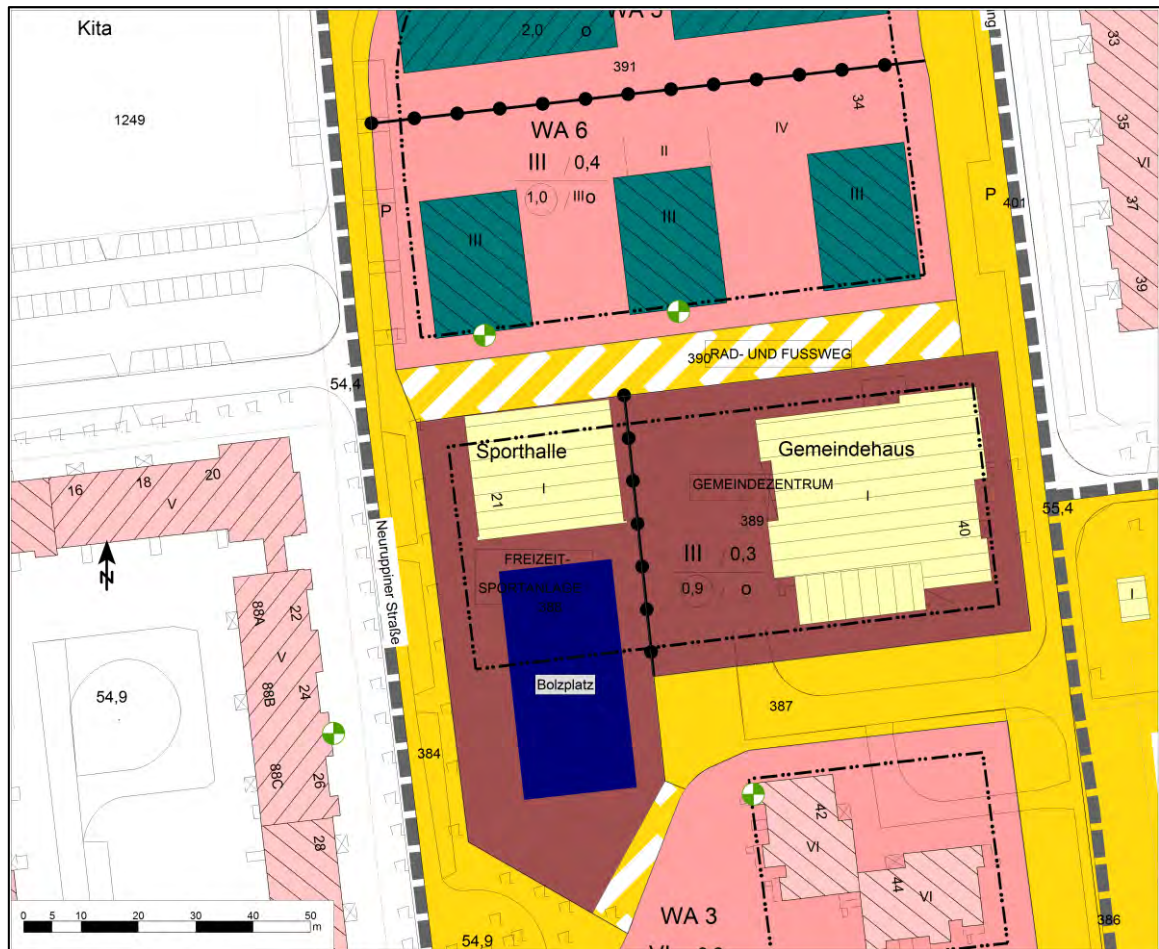
Abbildung 28: Lageplan des Berechnungsmodells mit Bolzplatz und Immissionsorten
