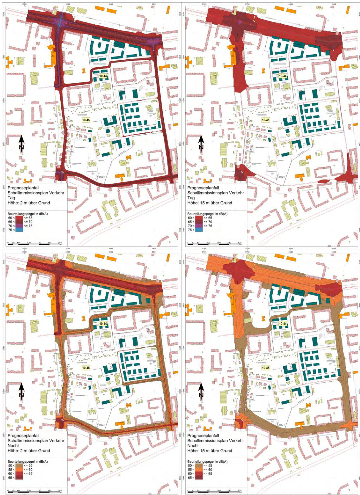
Abbildung 63: Schallimmissionspläne für Verkehrslärm im Prognoseplanfall: Bereiche 2/15 m (linke/rechte Bilder) Höhe ü. G. mit Überschreitungen der schalltechnischen Orientierungswerte tags/nachts (Bilder unten/oben) von 60/50 dB(A) für Mischgebiete gemäß Beiblatt 1 zu DIN 18005-1
