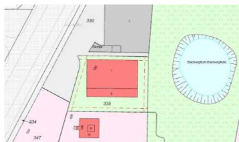
Flurstück 335, Abstandsflächen mit Gebäudekörper der Bestandssporthalle © FIS-Broker
