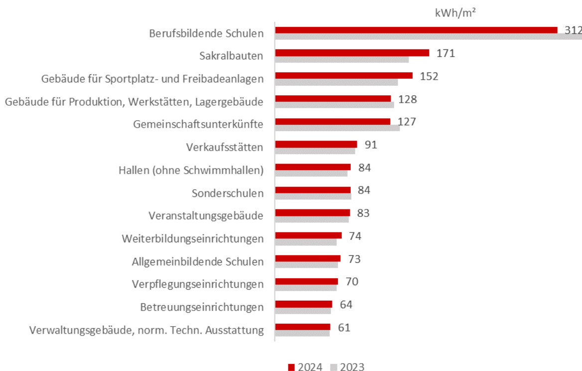
Abbildung 16: Durchschnittliche Wärmeverbrauchskennzahlen der Gebäudekategorien (grau: Vorjahr)
