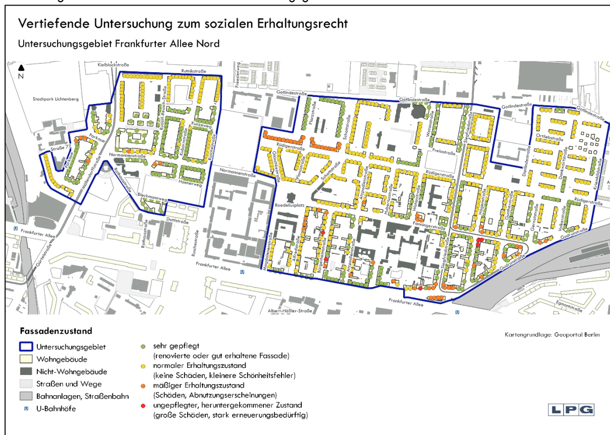
Abbildung 25: Fassadenzustand im Untersuchungsgebiet
