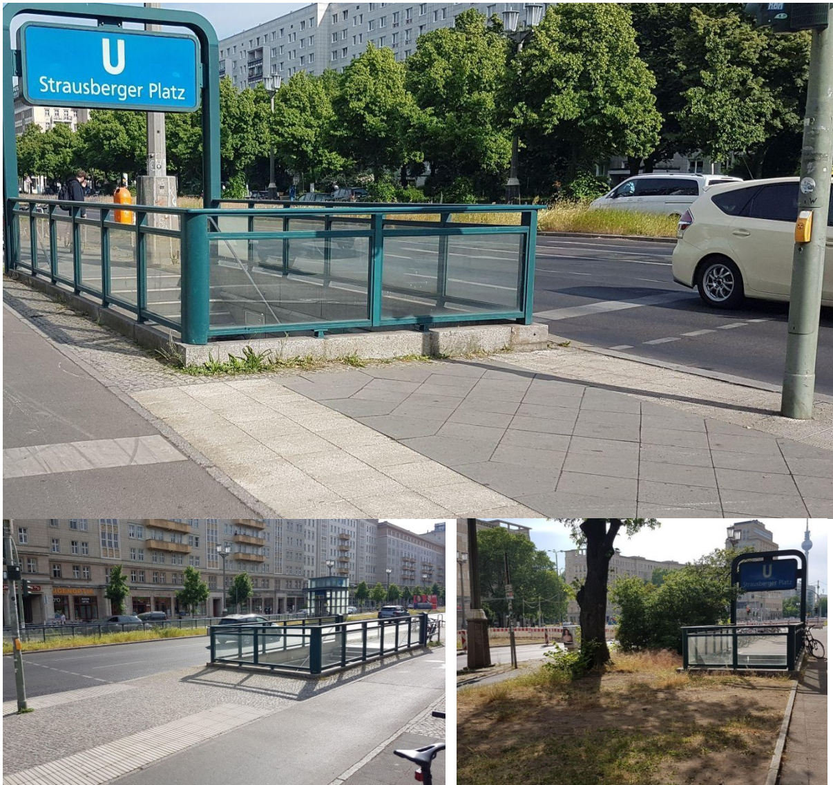
Abb. 5.24 Negativ-Beispiel für U-Bahn-Treppenaugänge, die wegen der Flächenkonkurrenz mit Fußgängerquerungen und Stadtgrün nicht geeignet für Radabstellanlagen sind.
