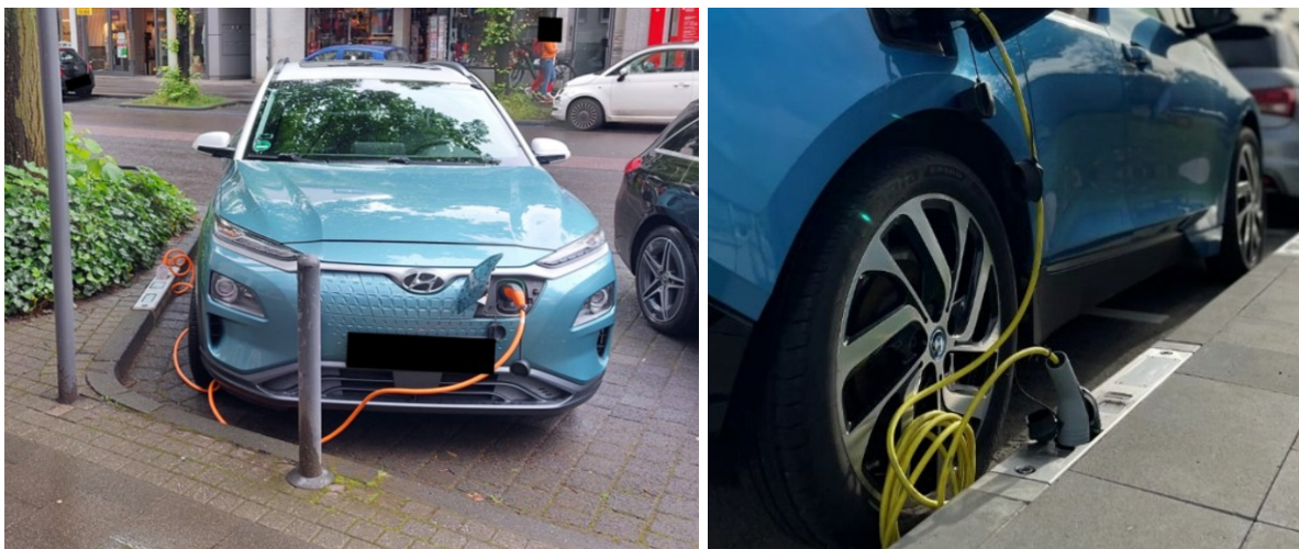
Abb. 5.10 Modell "Curb Charger" der Firma Pierburg, Das Lademodul findet in einem Beton-Hohlkörper von der Größe eines üblichen Hochbordsteins Platz. Ein externer Stromanschlusskasten ist erforderlich. (© Pierburg / Rheinmetall AG)
