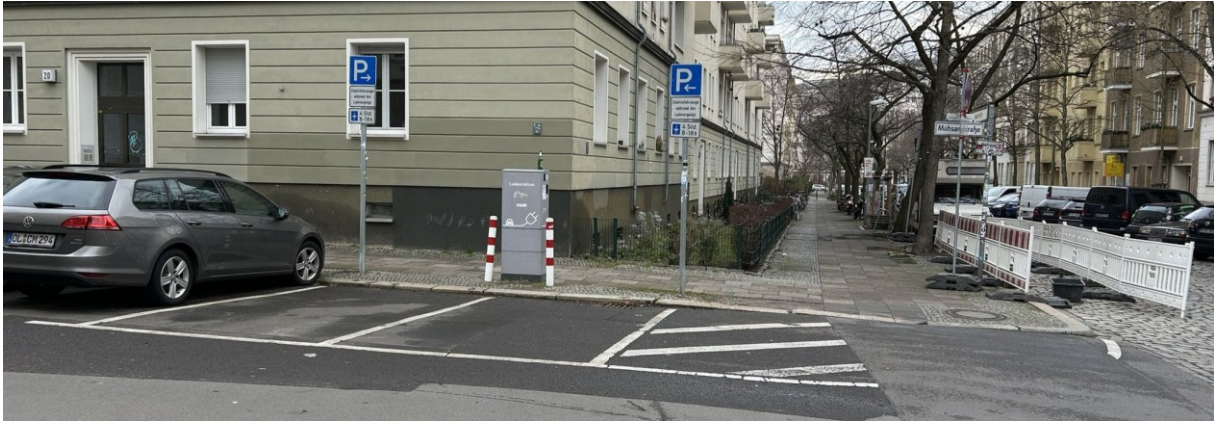
Abb. 5.3 Potenzialstandort für eine barrierefreie E-Auto-Ladestation, wo durch breitere Kfz-Parkstände und abgesenkte Bordsteine ein barrierefreier Zugang auch für mobilitätseingeschränkte Personen garantiert werden könnte
