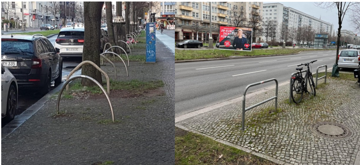
Abb. 5.17 Mischung aus Baumschutzbügeln sowie Anlehnbügeln in Rechteck- und Halbkreisform
