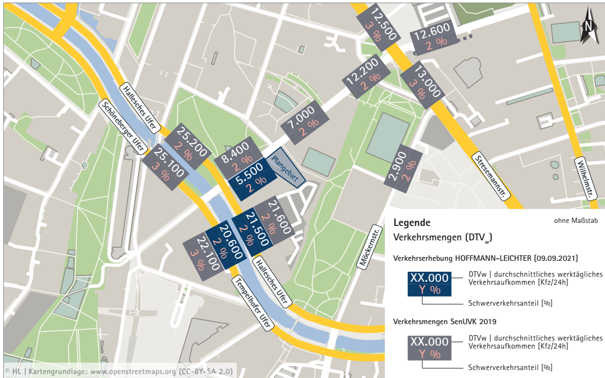
Abbildung 17 Durchschnittliches werktätliches Verkehrsaufkommen im Bestand
