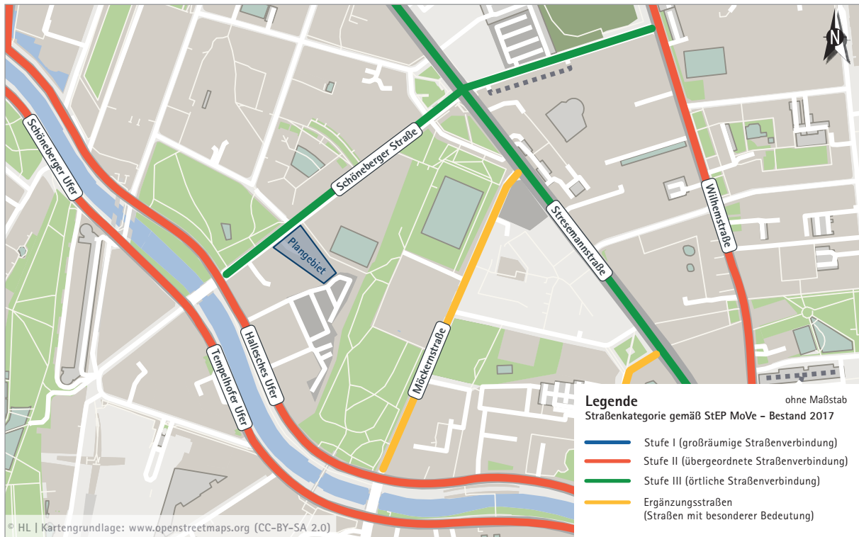
Abbildung 10 Erschließung des Plangebiets durch den motorisierten Individualverkehr (StEP Verkehr)
