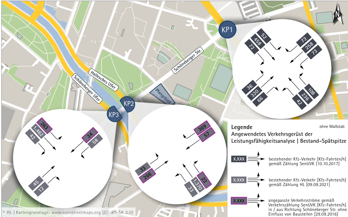
Abbildung 14 Angewandtes Mengengerüst für die Leistungsfähigkeitsanalyse | Bestand Spätspitze
