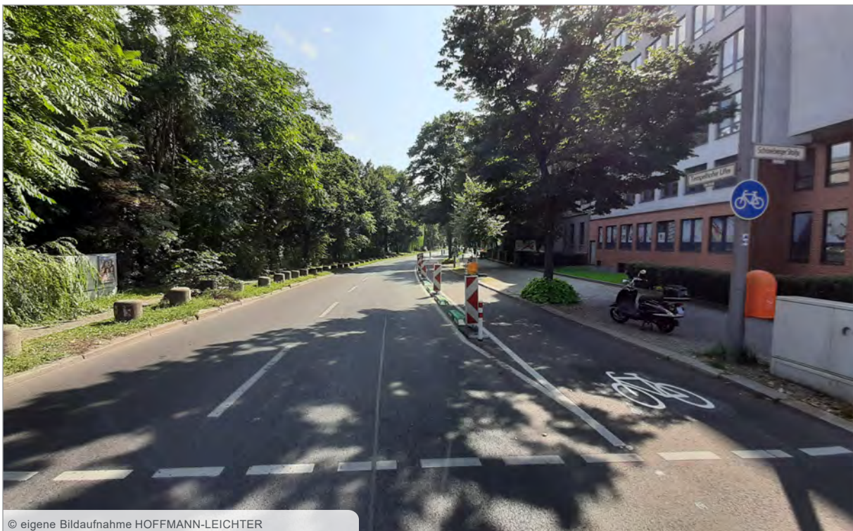
Abbildung 6 Geschützter Radfahrstreifen entlang des Ufers am Landwehrkanal (hier bsph. Tempelhofer Ufer)
