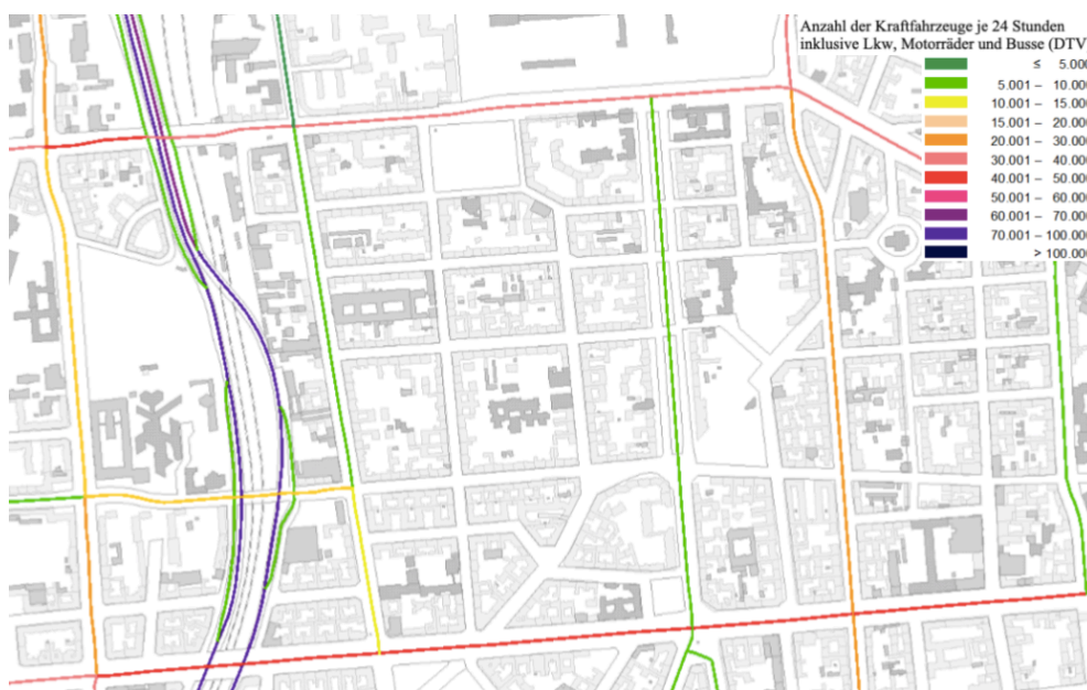
Abbildung 7: Verkehrsmengen - Anzahl der Kraftfahrzeuge je 24 Stunden inklusive Lkw, Motorräder und Busse (DTV) (Umweltatlas Berlin / [Verkehrsmengen 2014])
