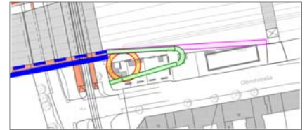
Mögliche Lösungen für eine barrierefreie Zugangsrampe: Spindel (orange), Bogen (grün) und Gerade (pink)
