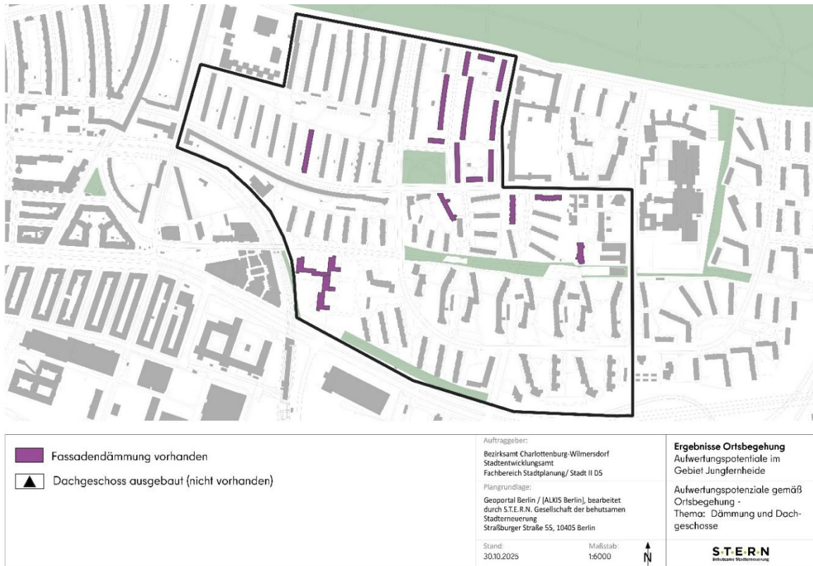
Abbildung 35: Einschätzung der Sanierungspotenziale gemäß der Ortsbegehung – Fassadendämmung
