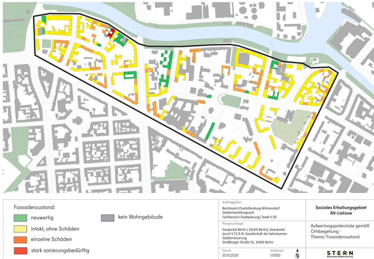
Abbildung 10: Einschätzung der Sanierungspotenziale gemäß der Ortsbegehung - Fassadenzustand
