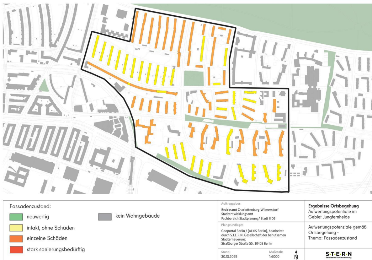
Abbildung 34: Einschätzung der Sanierungspotenziale gemäß der Ortsbegehung – Fassadenzustand
