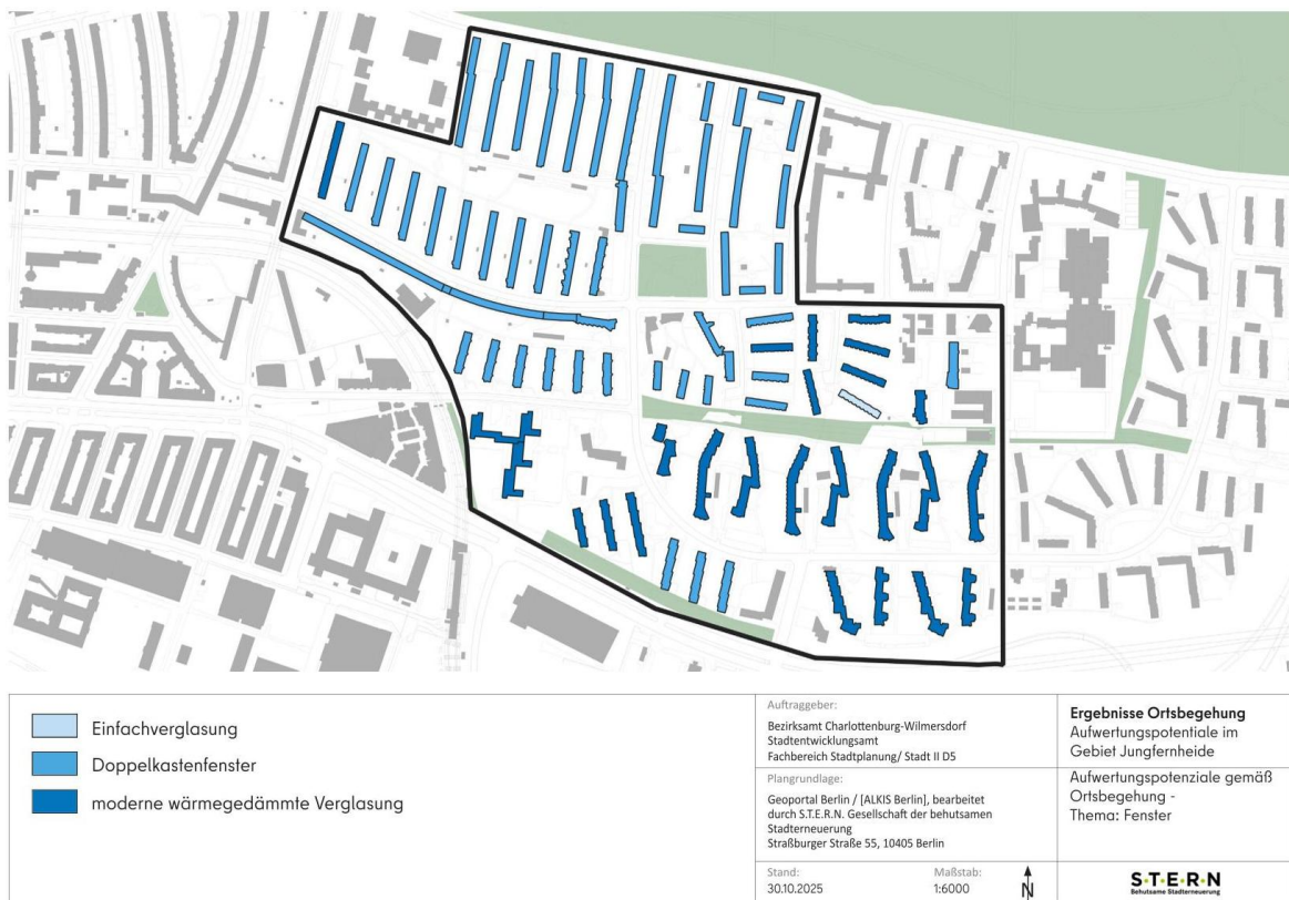
Abbildung 36: Einschätzung der Sanierungspotenziale gemäß der Ortsbegehung – Fensterzustand
