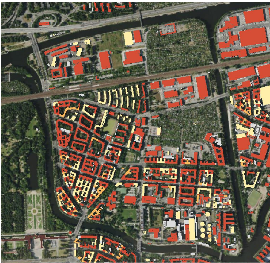
Abb.9. Solarflächenpotential der gewerblichen Dachflächen (Rot = Sehr gut, Weiß = wenig geeignet)
